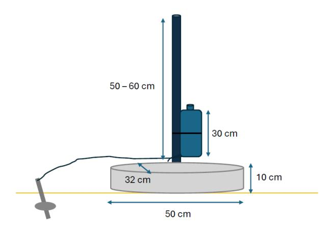
Schéma d'installation du dispositif d'écoute
